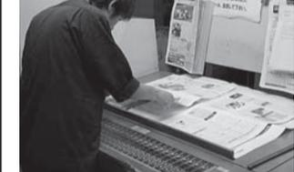
印字の色の乗りは印刷機の稼働時間や紙の質感、天候などによって変化する。印刷中は全ての学報の印字が均一な色味になるように輪転印刷機の回転数やインキの量を一括で管理する検紙台に検紙員が立ち、常に微調整を行っている。また10分ごとに仕上がった学報を肉眼で見ても、紙面に色合いの変化が起きていないか確認している。最後には人の目が頼りとなるのだ。
