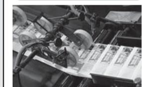
印刷された一枚続きの用紙は折り機で畳まれ、タブロイド判の大きさに裁断される。紙面の左右がギザギザしているのは裁断する刃がノコギリのような形状をしているため。
