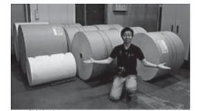
「巻取」と呼ばれる大きなロール紙が輪転印刷機に設置される。約2万部の学報には重さ約1トンの用紙が必要となる。
